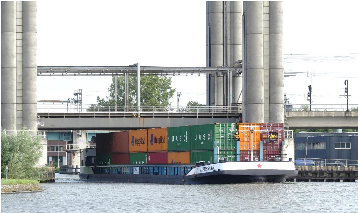
De Alphenaar vaart geladen met containers onder de spoorbrug door (doorvaarthoogte 7 meter)
