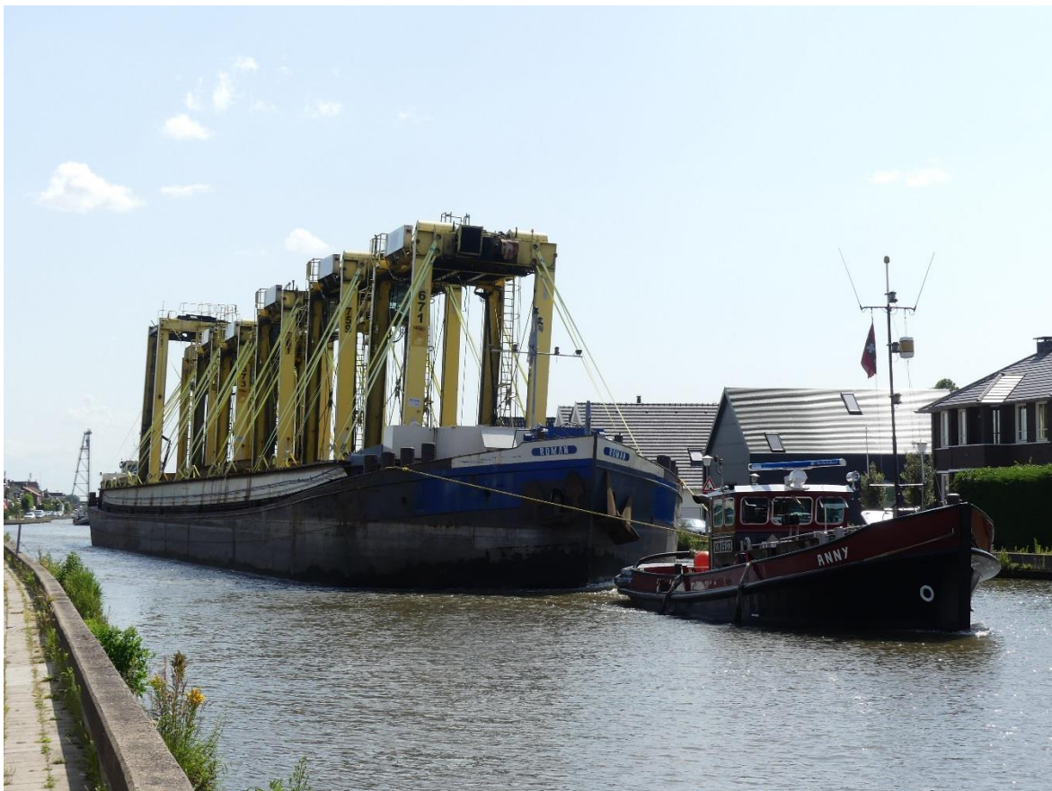
Speciaal transport op de Gouwe: kranen uit Antwerpen. Lengte x breedte: 116 x 12 meter.
