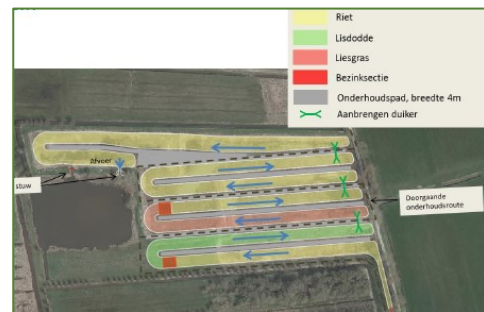
Figuur 17 Ontwerp helofytenfilter Pompveld
